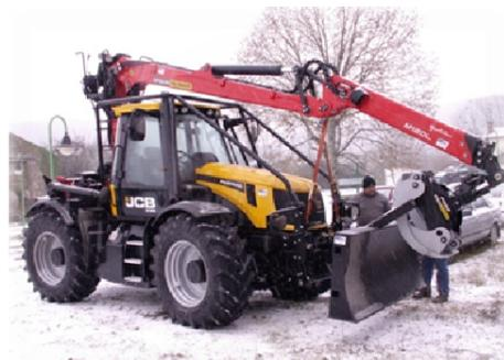
**Le tracteur à 4 roues motrices et directionnelles** est un engin tout terrain qui peut s'adapter à quasiment toutes les situations. Il est muni d'une grue forestière et d'un treuil.
