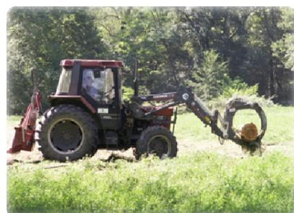
**Le tracteur agricole** est très pratique pour le débardage des arbres. Equipé d'une pince, il permet de déplacer et de trier arbres et branches sur le chantier.
